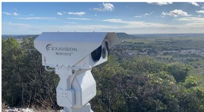
Face à l'augmentation des feux de forêt et dans l'objectif d'utiliser les moyens humains différemment, Exavision propose NEMOSYS FIRE, un système de surveillance intelligent basé sur l'installation d'un réseau de caméras thermiques et de capteurs haute résolution sur tout le territoire gardois. Déployé par le SDIS 30 avec le soutien du Fonds Vert et du ministère de l'Agriculture, le dispositif repose sur **une technologie de détection thermique**
